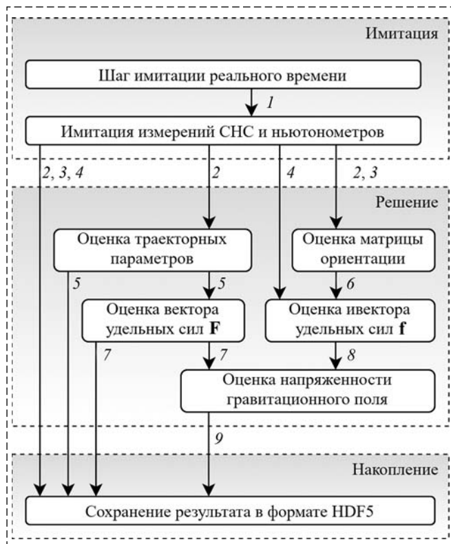
Рис. 1. Структура одной итерации работы программы Fig. 1. Structure of single iteration of the program
