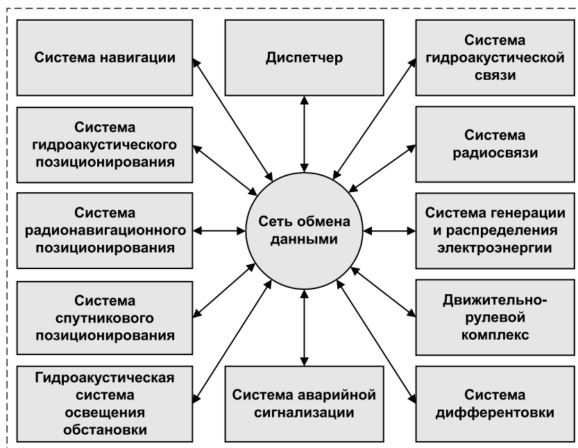
Рис. 1. Структурная схема СУ АНПА Fig. 1. Structural diagram of AUV control system
