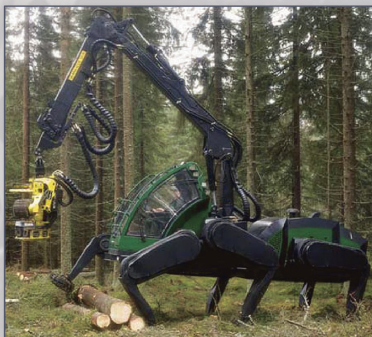
Рис. 1. Шагающая машина для лесозаготовок «Plustech» (a) и дождевальная машина «Кубань» с шагающими двигателями (б)
