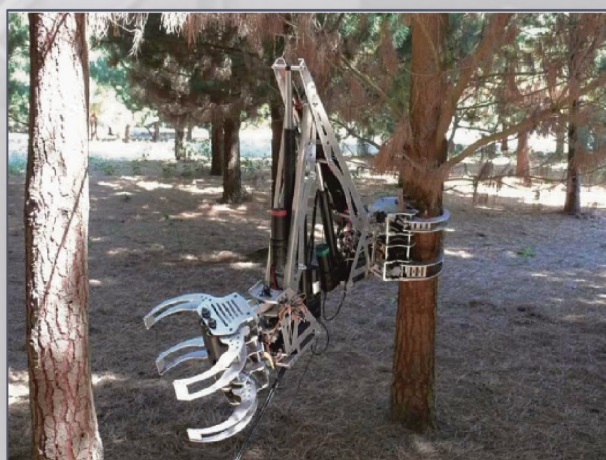
Рис. 2. Робот, перемещающийся по деревьям (Scion)
