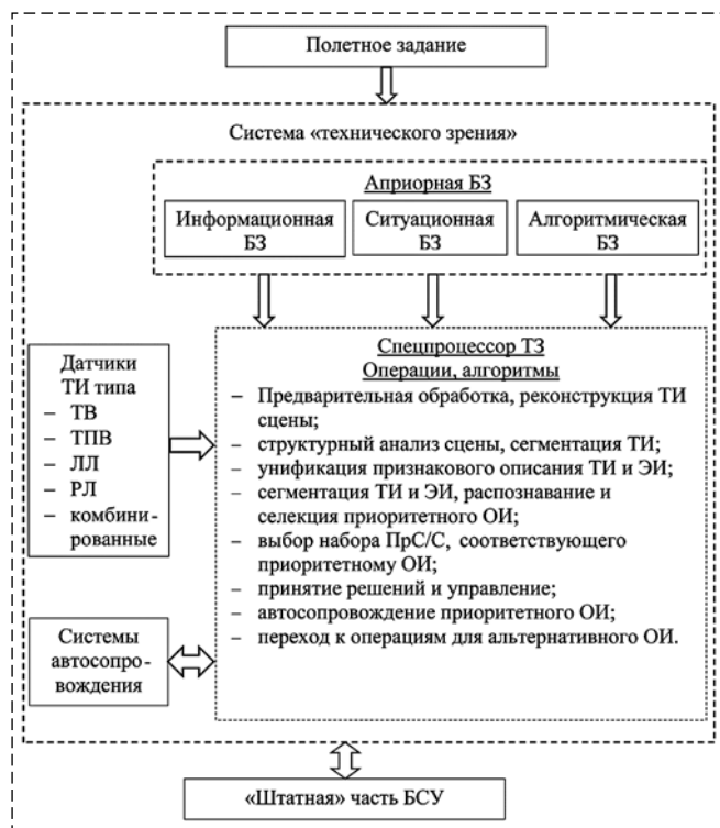
Рис. 3. Функциональная схема "интеллектуальной" составляющей бортовой системы технического зрения
