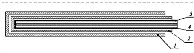
Рис. 3. Телескопическая структура спицы
