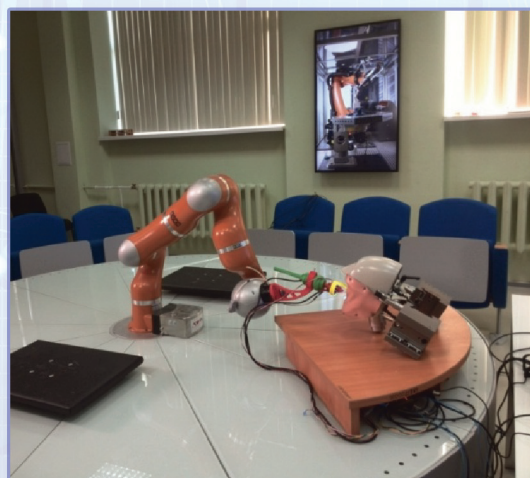
Рис. 2. Экспериментальный стенд роботической биопечати эмали in situ
