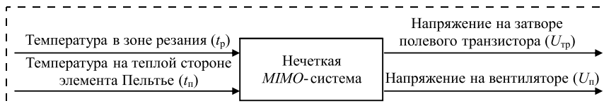
Рис. 2. Нечетко-логическая MIMO-система для управления параметрами автономной системы охлаждения режущего инструмента
