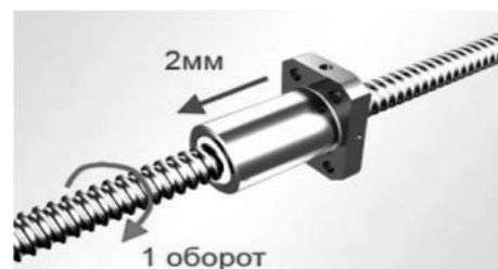
Рис. 4. Перемещение гайки суппорта станка по трап-валу
