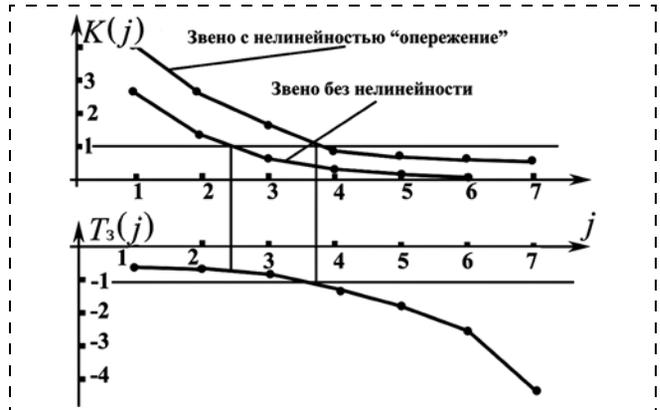
Рис. 16. Функциональные зависимости  $K(j)$  и  $T_3(j)$  для системы, включающей нелинейность типа "опережение" и системы, не содержащей нелинейность
