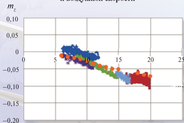
Рис. 6. Сравнение полученных оценок коэффициента момента тангажа с данными банка аэродинамических характеристик, конфигурация 2
