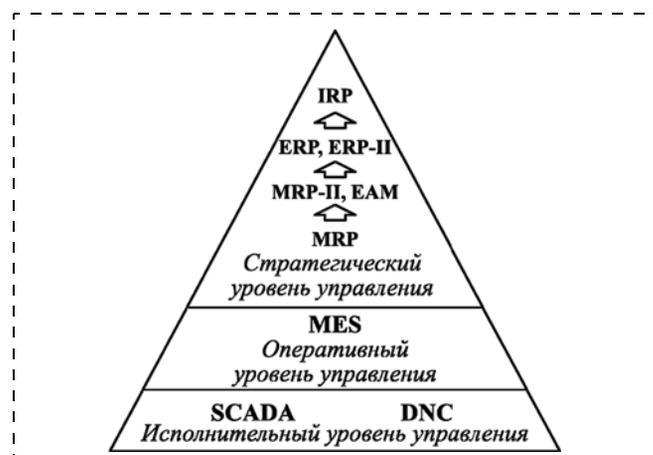
Рис. 1. Иерархия средств автоматизации производства
