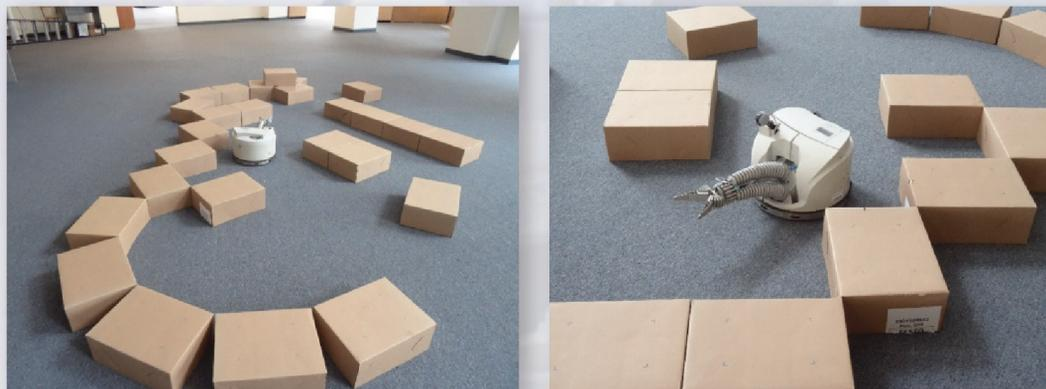
Рис. 5. Движение робота Robotino в среде с препятствиями
