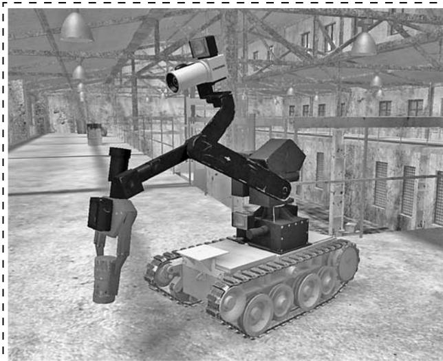
Рис. 5. Захват контейнера с помощью робота MF-4
