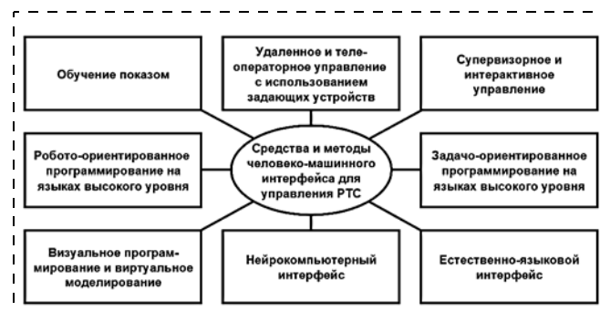
Рис. 1. Классификация средств и методов человеко-машинного интерфейса в составе робототехнических систем
