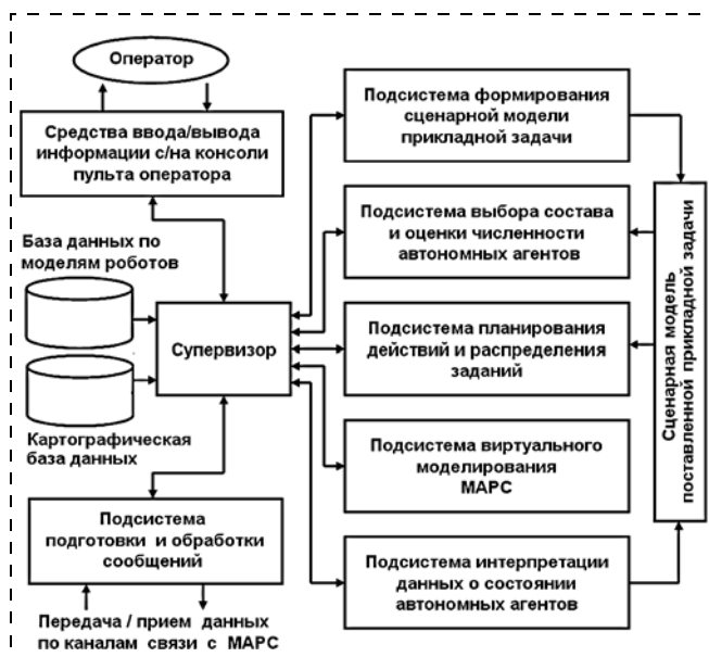
Рис. 9. Функциональная структура программно-алгоритмического обеспечения человеко-машинного интерфейса в составе МАРС
