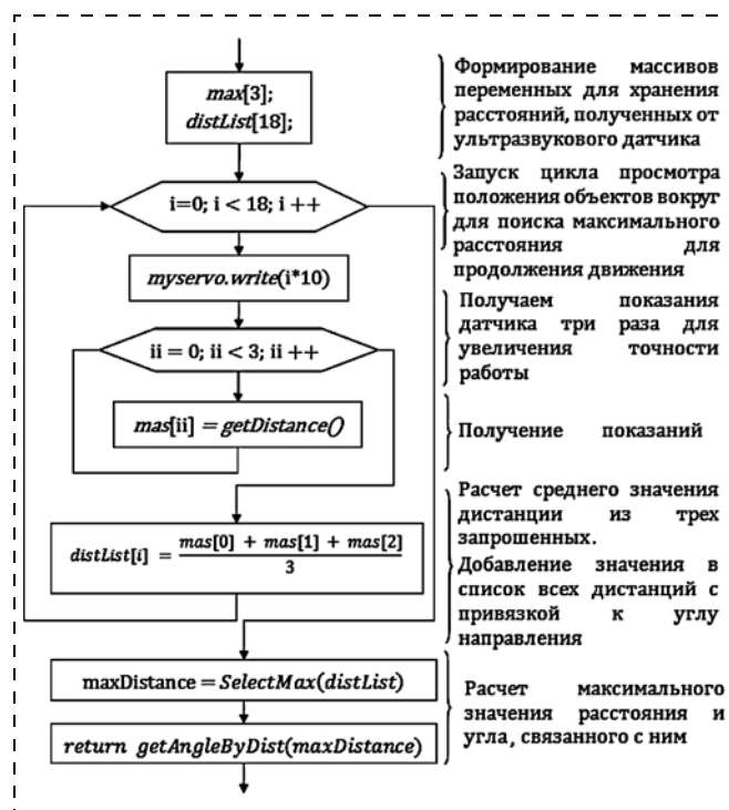
Рис. 4. Блок-схема алгоритма определения максимального расстояния и связанного с ним угла
