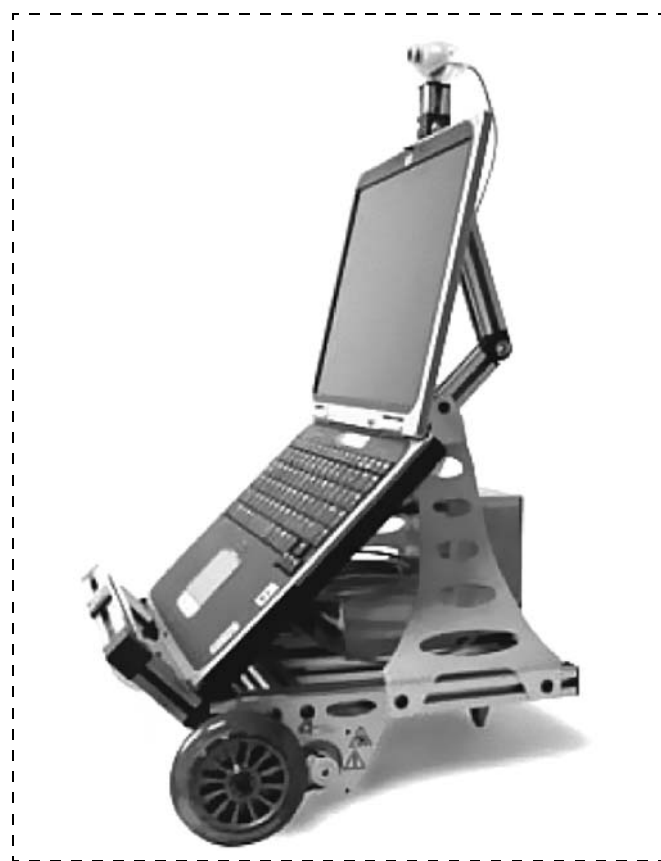
Рис. 2. Персональный робот ER-1 (Evolution Robotics, USA)
