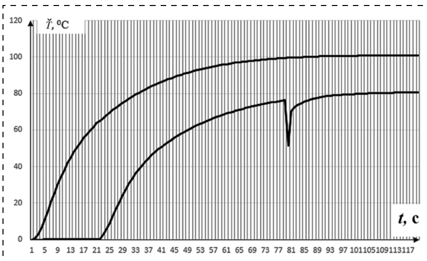
Рис. 4. Переходные характеристики при регулировании температуры в двух зонах
