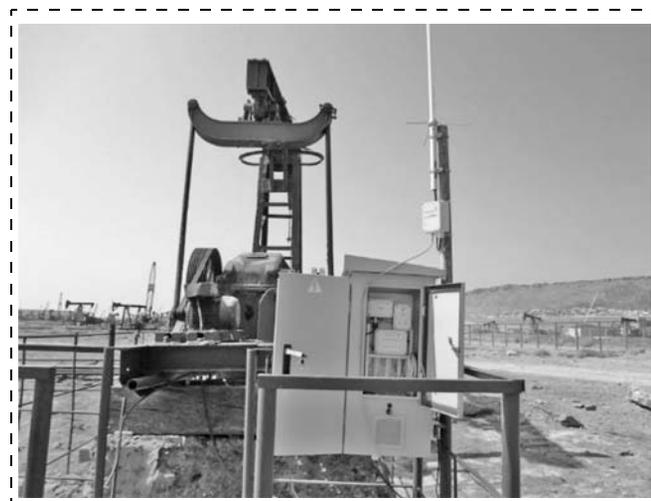
Рис. 5. Внешний вид СРУ на станке-качалке установки ШГНУ
