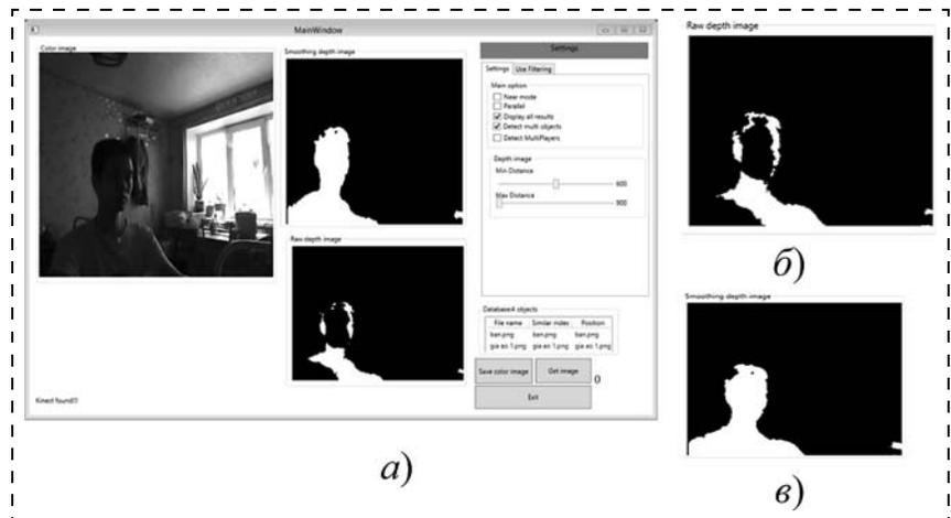
Рис. 2. Получение глубин изображения с датчика Kinect:
