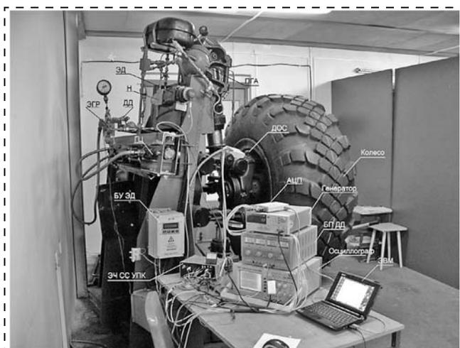
Рис. 4. Стенд для физического моделирования электрогидравлического привода поворота колеса опорно-ходового модуля
