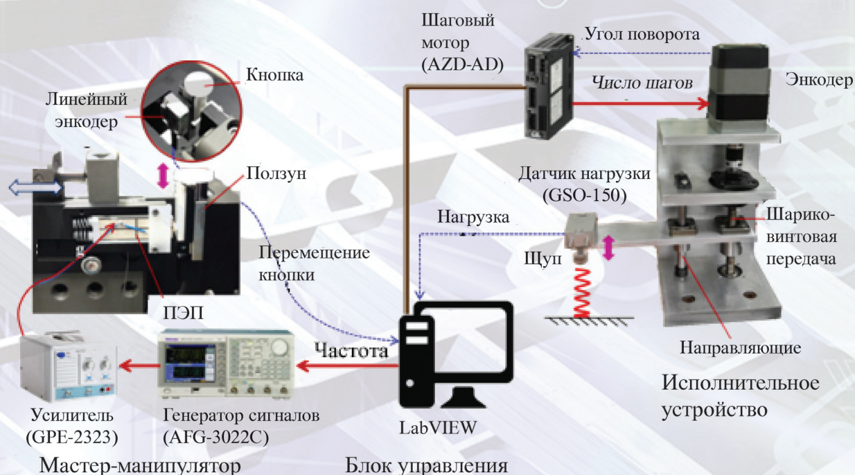
Рис. 1. Структура прототипа тактильного устройства
