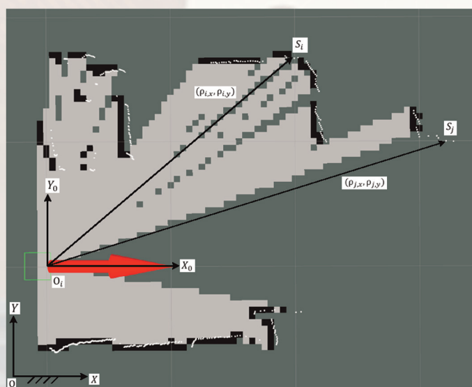
Рис. 5. Определение собственного положения и построение карты: а – один скан лазерного сканера; б – процесс SLAM
