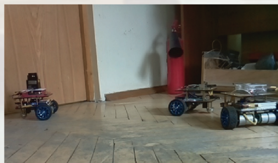
Рис. 9. Движение группы роботов в строю типа «конвой»: а – траектории роботов R_0 (черная), R_1 (синяя), R_2 (зеленая); б – фотография, полученная с камеры, установленной на роботе R_4
