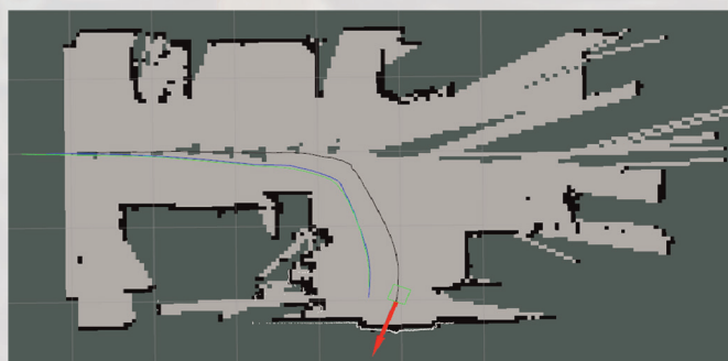
Рис. 9. Движение группы роботов в строю типа «конвой»: а – траектории роботов R_0 (черная), R_1 (синяя), R_2 (зеленая); б – фотография, полученная с камеры, установленной на роботе R_4
