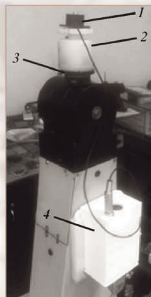
Рис. 10. Пассивный биомехатронный модуль с силовым тензодатчиком: 1 – тензодатчик; 2 – переходник; 3 – фланец робота; 4 – кассета интерфейса
