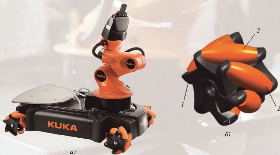
Рис. 1. Мобильный робот всенаправленного движения youBot : а – общий вид робота с одним манипулятором с устройством захвата; б – роликонесущее меканум-колесо (1 – диск колеса; 2 – ролики)
