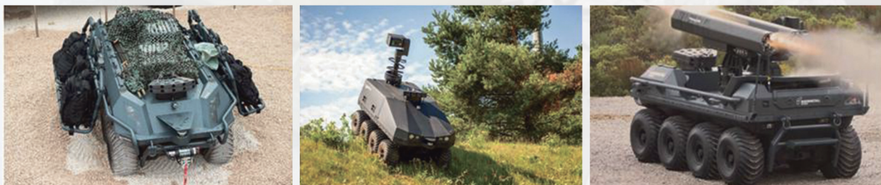
Рис. 4. Различные полезные нагрузки на базовой платформе Rheinmetall Mission Master (Германия) Fig. 4. Various loads on Rheinmetall Mission Master basic platform
