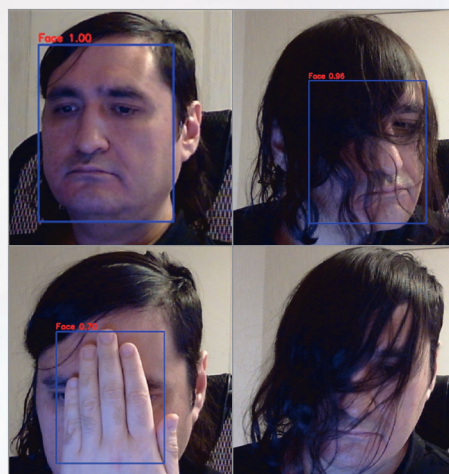
Рис. 9. Тестирование подсистемы технического зрения робота Sphinx на базе нейронной сети Yolo 3 в блоке нейронной обработки NPU с применением библиотеки OpenCV Fig. 9. Testing the Sphinx robot vision subsystem based on the Yolo 3 neural network in the NPU neural processing unit using the OpenCV library
