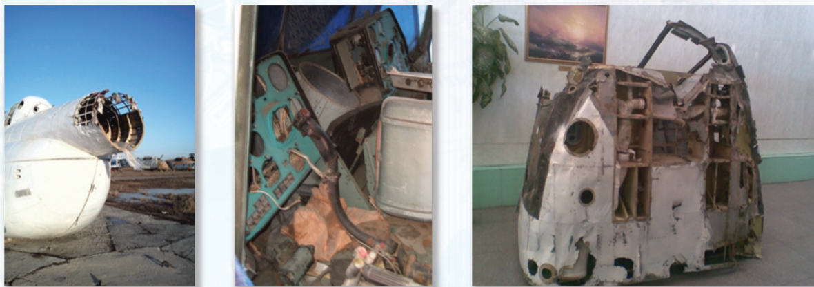
Рис. 1. Повреждения вертолета МИ-8, полученные в процессе его эксплуатации Fig. 1. Damage to the MI-8 helicopter during exploitation
