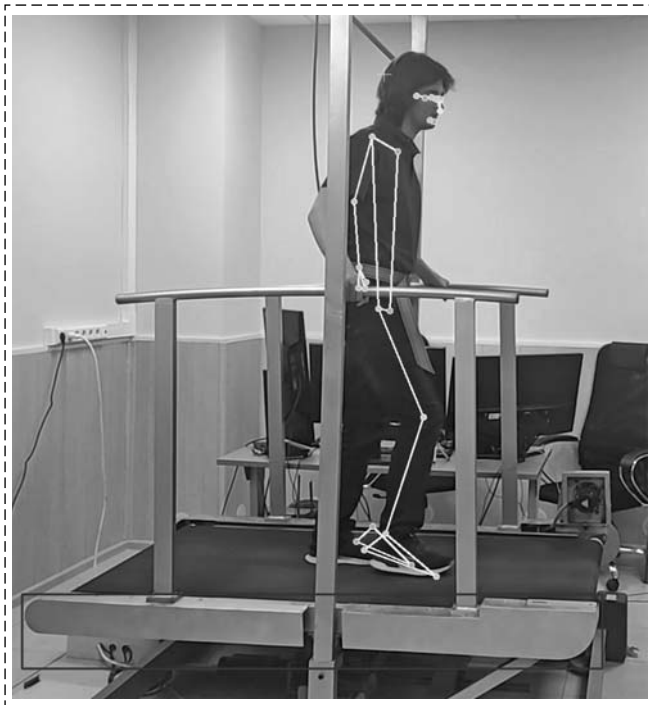
Рис. 2. Распознанные объекты: беговая платформа и человек на ней Fig. 2. Recognized objects: the running platform and the person on it
