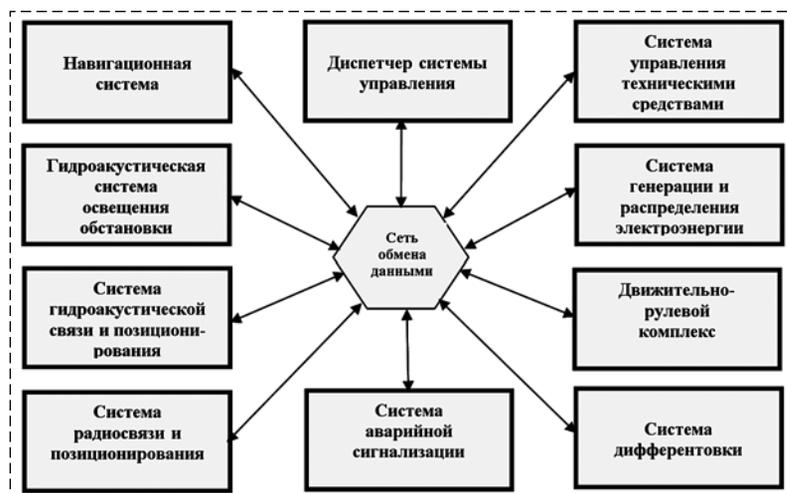
Рис. 1. Структурная схема мультиагентной системы управления АНПА
