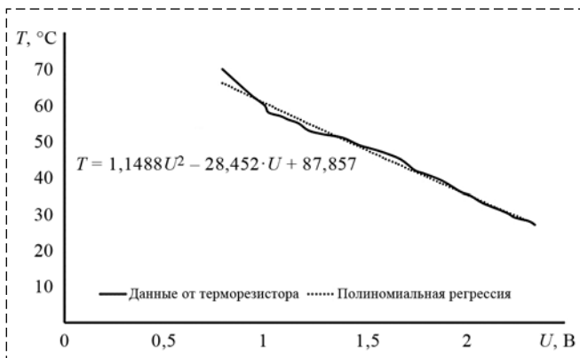
Рис. 3. Калибровка термистора Fig. 3. Thermistor calibration
