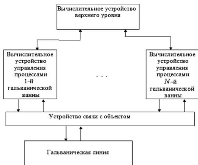
Рис. 4. Двухуровневая архитектура системы управления гальванической линией
