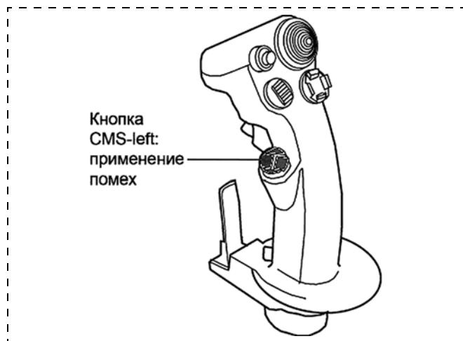
Рис. 6. Органы управления (на РУС) постановкой помех противнику
