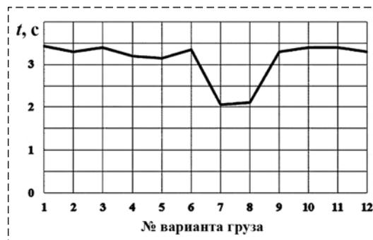
Рис. 5. Время регулирования линейного перемещения груза по вариантам груза
