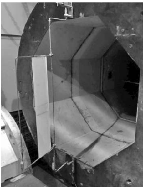
Рис. 5. Двухзвенный аэродинамический маятник в аэродинамической трубе
