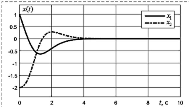
Рис. 3. Переходные процессы для вектора переменных состояния  $x(t)$  при  $\alpha = 1$
