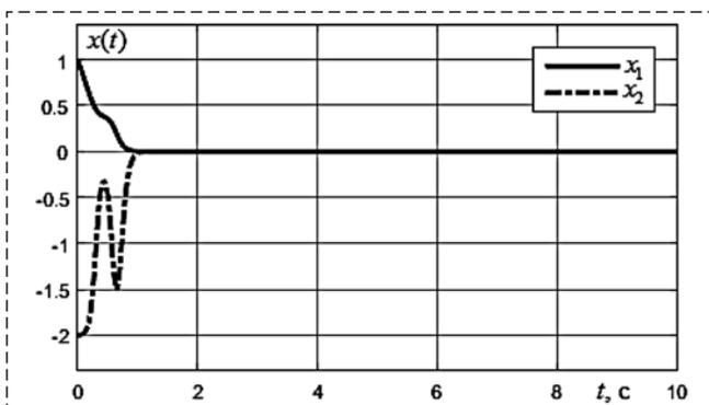
Рис. 5. Переходные процессы для вектора переменных состояния  $x(t)$  при  $\alpha = 10$
