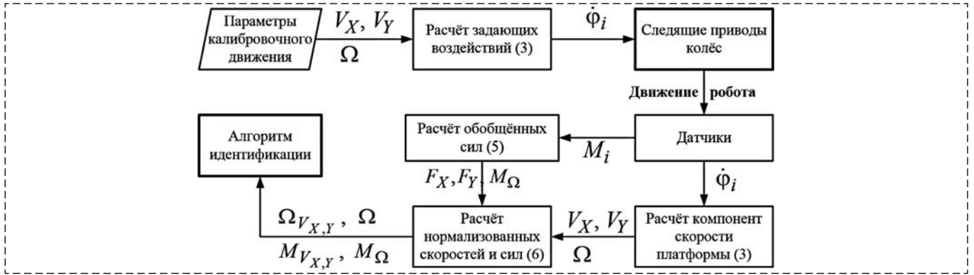
Рис. 4. Схема получения экспериментальных данных для решения задачи идентификации
