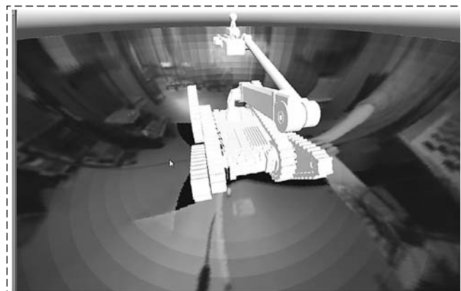
Рис. 10. Совмещение видеосцены с 3D-моделью робота Fig. 10. A combining the video scene with a 3D-model of the robot
