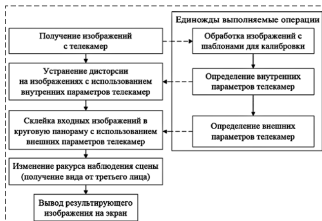
Рис. 3. Блок-схема работы алгоритма Fig. 3. A block diagram of the algorithm
