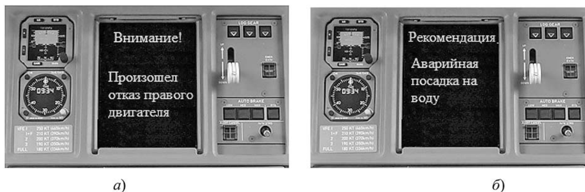
Рис. 2. Коллизия "ТС "Уход на заданный аэродром" — Угроза "Отказ правого двигателя":
