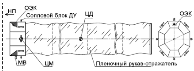
Рис. 2. Схема свободнолетающего КА-ведомого:
