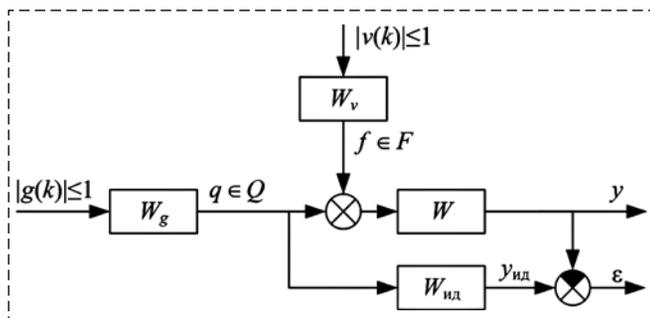
Рис. 2. Схема фильтрации после введения дополнительных звеньев
