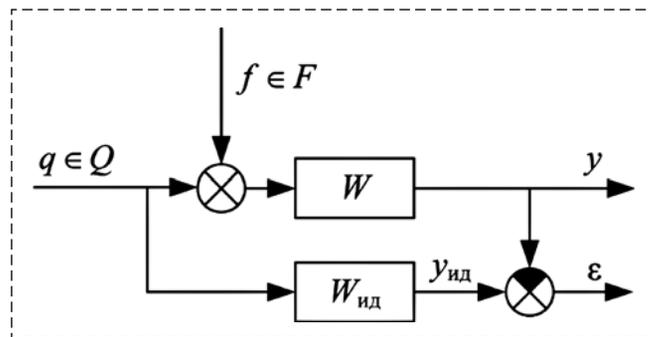
Рис. 1. Исходная схема фильтрации
