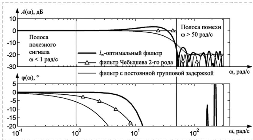
Рис. 4. АЧХ и ФЧХ различных фильтров
