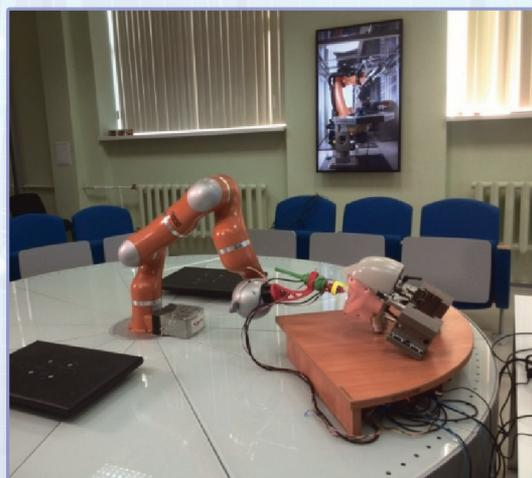
Рис. 2. Экспериментальный стенд роботической биопечати эмали in situ
