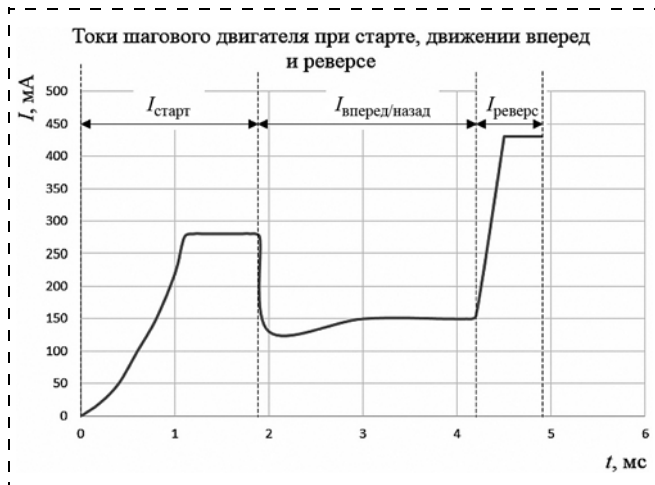
Рис. 7. Изменение силы тока при работе шагового двигателя
