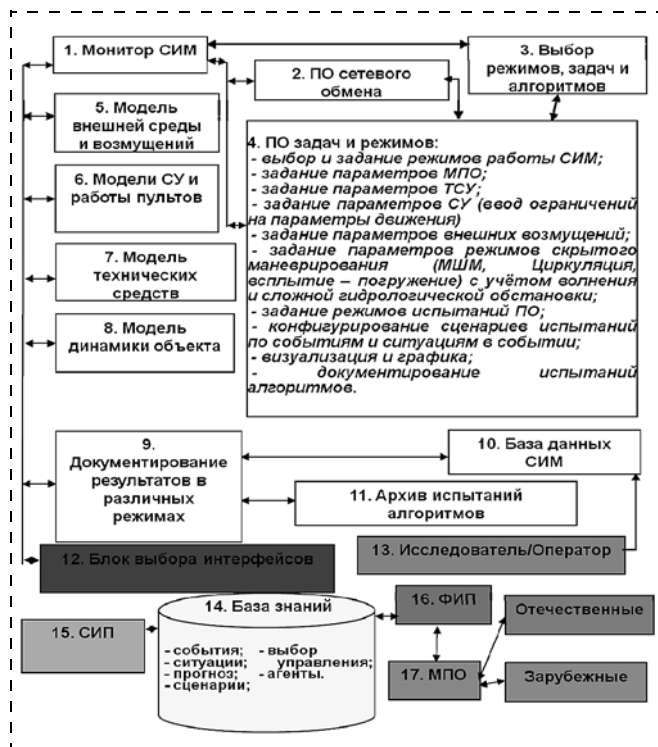
Рис. 2. Структура разрабатываемой СИМ (ТСУ — технические средства управления; МШМ — малозумное маневрирование; ФИП — функции информационной поддержки; СИП — система информационной поддержки)
