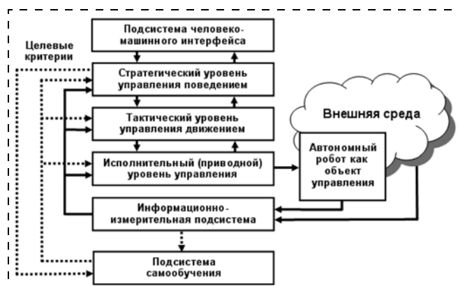
Рис. 1. Обобщенная структура интеллектуальной системы управления автономным роботом с контуром самообучения
