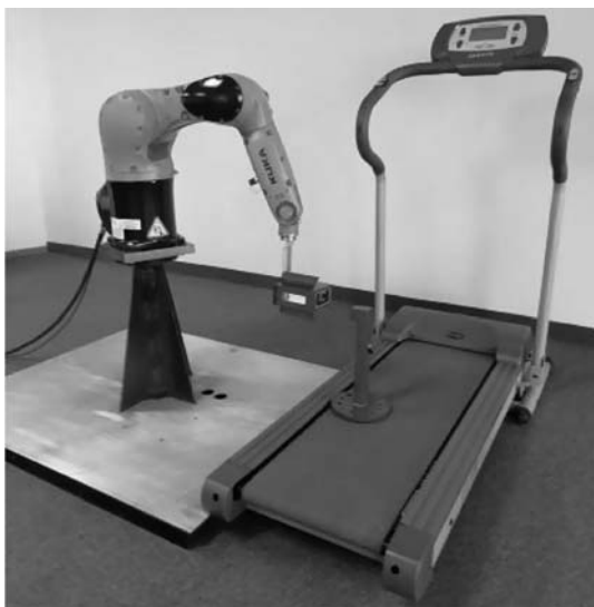
Рис. 8. Схема лабораторной установки, создающей ММ дополнительную степень подвижности
