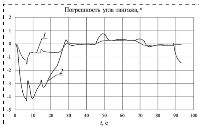
Рис. 9. Погрешности угла тангажа: 1 — РБСО с отключением коррекции; 2 — РБСО без отключения коррекции
