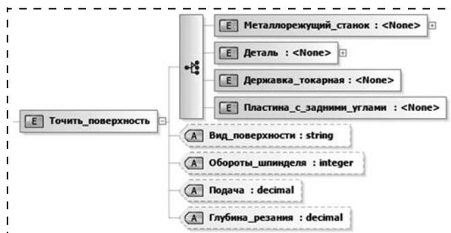
Рис. 2. Элемент знаний перехода "точить поверхность"
