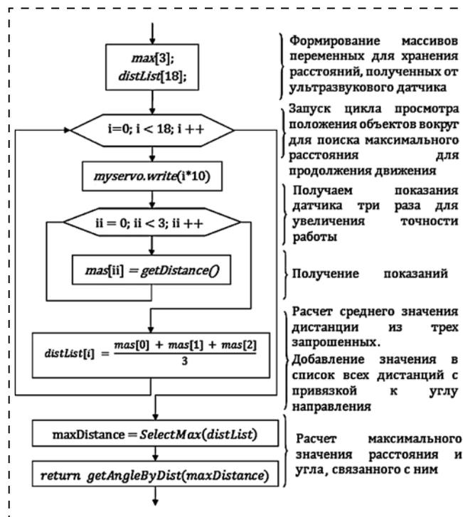
Формирование массивов переменных для хранения расстояний, полученных от ультразвукового датчика
