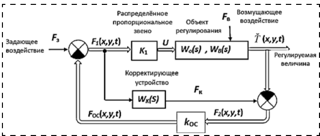
Рис. 1. Структурная схема САР с параллельным корректирующим устройством
