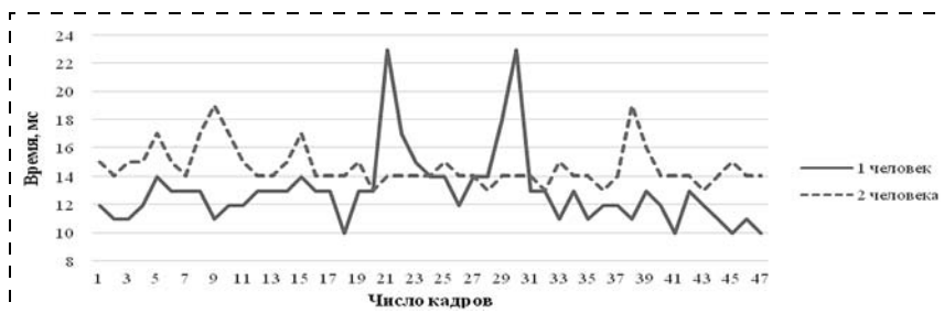
Рис. 9. Быстродействие алгоритма распознавания подвижных объектов
