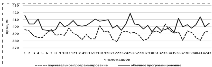
Рис. 7. Сравнение результатов при традиционной реализации и при использовании параллельного программирования
