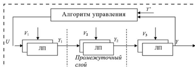
Рис. 3. Структура традиционной САУ многослойным процессом с неуправляемыми внутренними слоями
