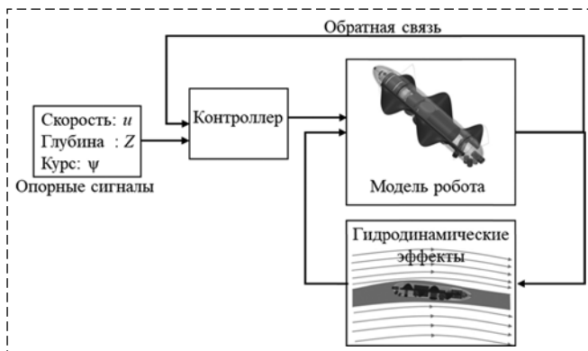
Рис. 5. Модель взаимодействия робота с окружающей средой Fig. 5. The model of robot interaction with environment
