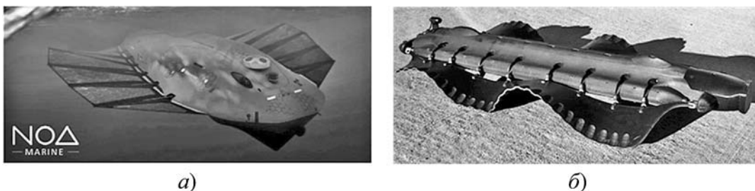
Рис. 1. Подводный робот Морской страж (Sea Sentinel) (а); робот с гибким движителем (Pliant Energy Systems) (б) Fig. 1. Underwater robot Sea Sentinel(a); Flexible Propulsion Robot (Pliant Energy Systems) (б)
